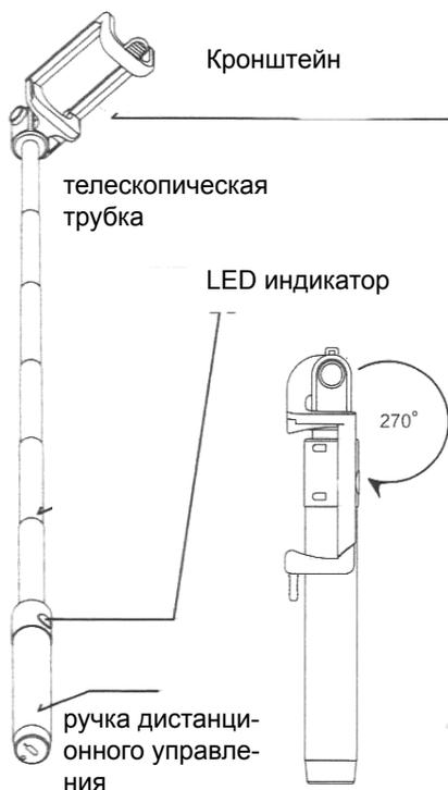
5. Взявшись за край телескопической трубки, необходимо постепенно сложить ее. Поверните кронштейн на 270 градусов, таким образом, вернув его в исходное положение. Храните устройство только в таком виде.
