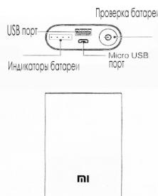
Внимание: «Проверка батареи» кнопка включения/выключения, данное устройство автоматически определяет заряд/разряд батареи. За две минуты до разряда, индикаторы количества электроэнергии отключаются.
